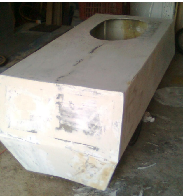
Carrosserie fabriquée avec un moule extérieur en tôles. Gel-coat appliqué directement sur le moule avant la résine et la fibre
