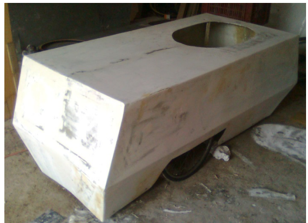
Carrosserie fabriquée avec un moule extérieur en tôles. Gel-coat appliqué directement sur le moule avant la résine et la fibre
