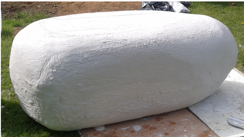
Moule intérieur fabriqué en polystyrène expansé recouvert de plâtre
